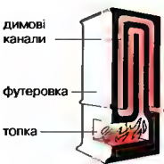
Кахельна пч для опалювання приміщень Футеровка нагрівається гарячим повітрям, що піднімається з топки
